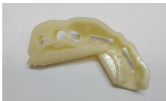
Obr. 7. Vytlačený navádzač na 3D tlačiarne Envisiontec Vida
