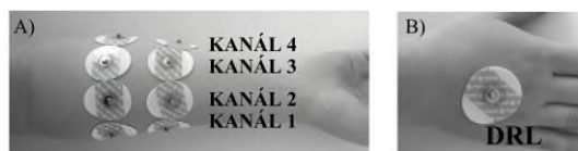
Obr. 2: Umiestnenie elektród: A) snímacie elektródy, B) DRL elektróda.
